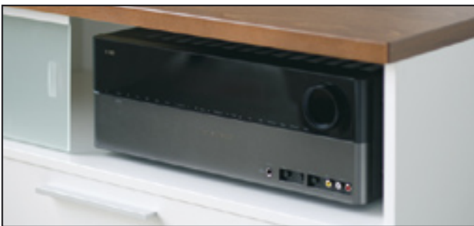
Aukon korkeudessa huomioitu audiolaitteiden mitat, sisäkorkeus 19 cm
